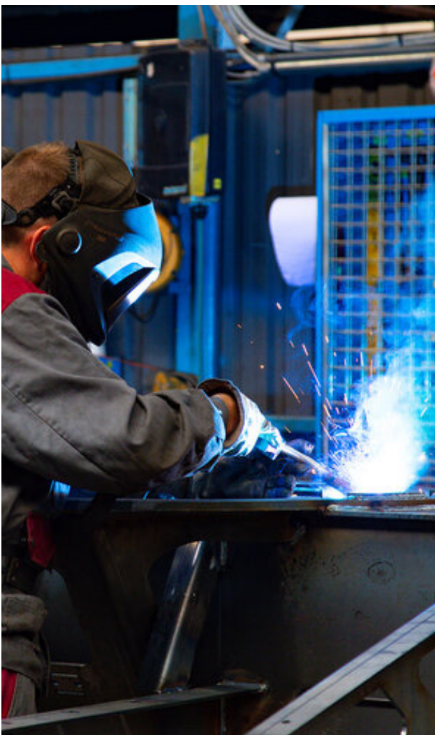
Operatore che effettua una saldatura MIG/MAG
