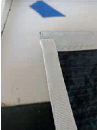
Dettaglio della fettuccia in nylon tagliata nella misura richiesta e rifinita.
