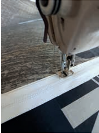
Cucitura alla sacca della fettuccia e della cerniera in un'unica volta-2.
