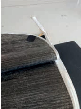
Applicazione della cerniera ad un bordo della sacca tramite nastro biadesivo-1.
