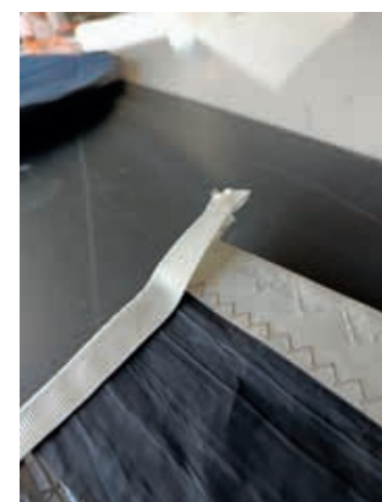
Dettaglio della fettuccia in nylon attaccata alla sacca tramite nastro biadesivo.
