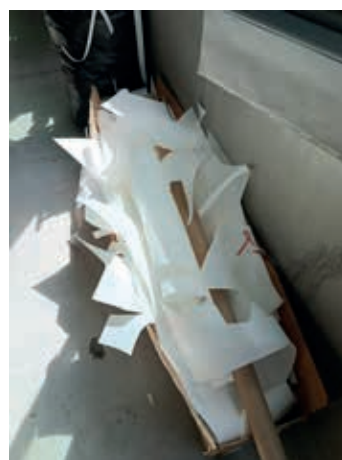
Scarti di produzione di dacron, impiegati come rinforzo nei punti più sollecitati.
