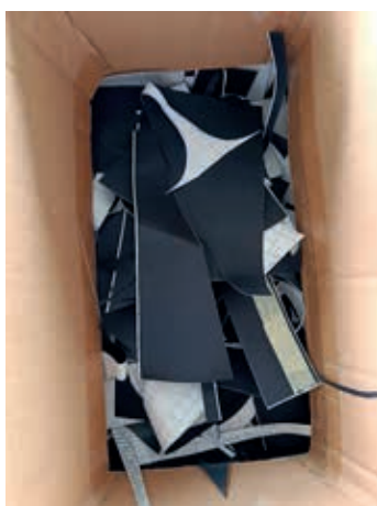
Scarti di produzione di dacron adesivo, impiegati come rinforzo nei punti più sollecitati.
