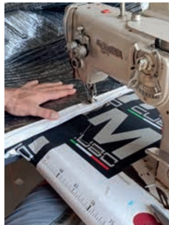
Cucitura alla sacca della fettuccia e della cerniera in un'unica volta-1.
