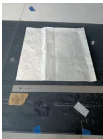
Misurazione e taglio del materiale ricavato da vela dismessa per realizzare una piccola sacca per il trasporto dei pali del tendalino.
