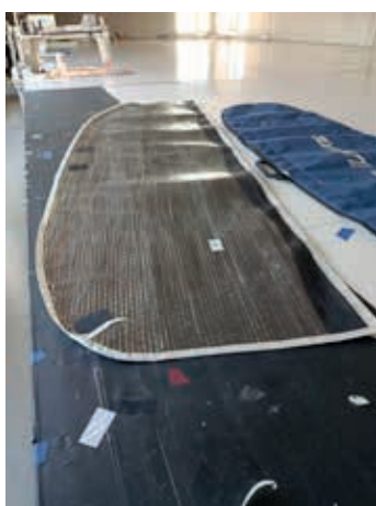
Applicazione della fettuccia in nylon lungo il bordo della sacca con nastro biadesivo-2.
