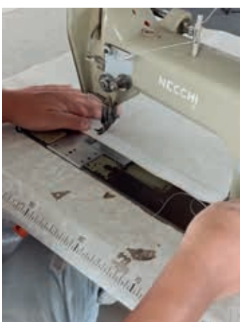
Cucitura del velco per la chiusura alla sacca per il trasporto dei pali.
