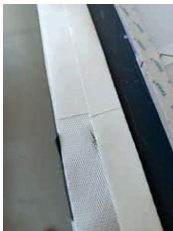
Dettaglio del biadesivo applicato alle fettucce in nylon.
