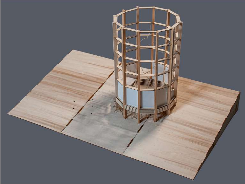
Fase 7 : Montaggio dei profili a "C" e dei listelli sui pilastri
