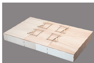
Fissaggio Ganci inferiori e superiori
